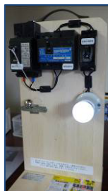
地震時電源自動遮断装置
